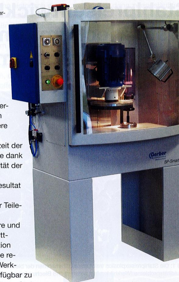
zum gleichmäßigen Entgraten der Matrizen und anderen Teilen im Werkzeugbau. Sie kann mit Naturhaarbürsten unter Verwendung einer Polierpaste, mit diamantdurchsetzten Bürsten unterschiedlicher Qualitäten oder auch Entgratbürsten bestückt werden.
